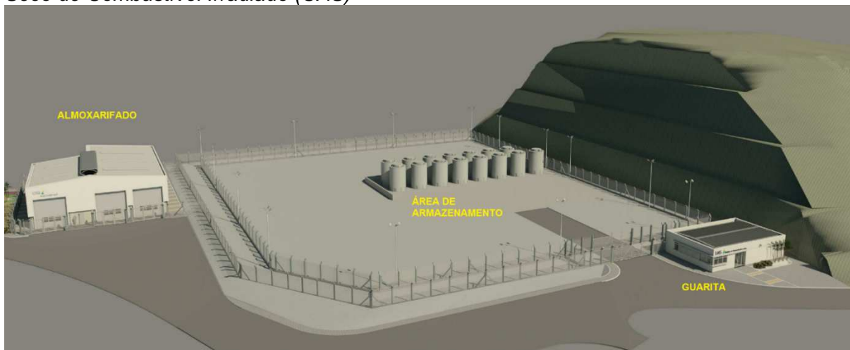
Figura 2-1 - Representação esquemática da Unidade de Armazenamento Complementar a Seco de Combustível Irrradiado (UAS)
